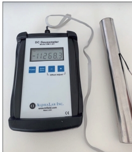
자석봉 자력 측정
